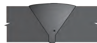
39 Porosity in Fillet (sub-surface) UT, RT
